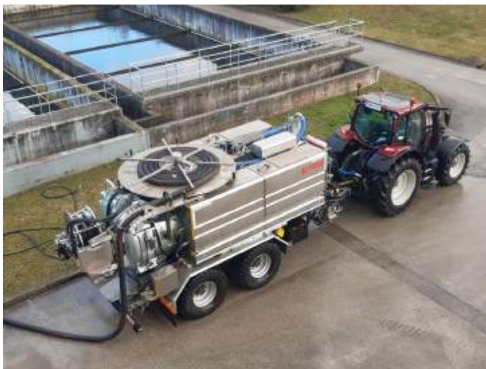
Nov traktor s cisterno za odvoz greznične gošče in blata iz MKČN
